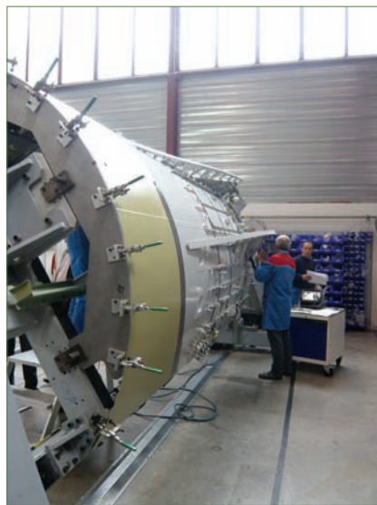
Montage d'une partie de fuselage pour Dassault, au sein des ateliers d'Eskulanak.
